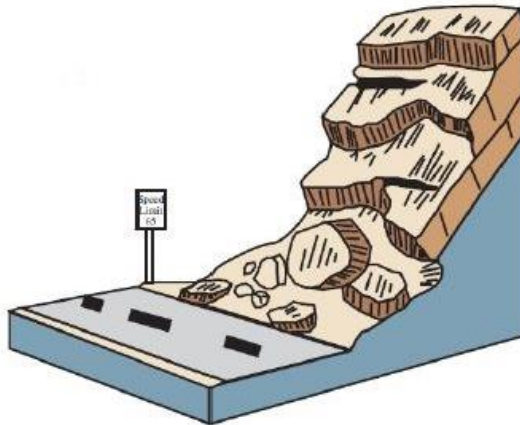
Figura 28: Caídas (Fall, Rockfall) (Fuente: Jan Novotný, según Vernes 1978).
