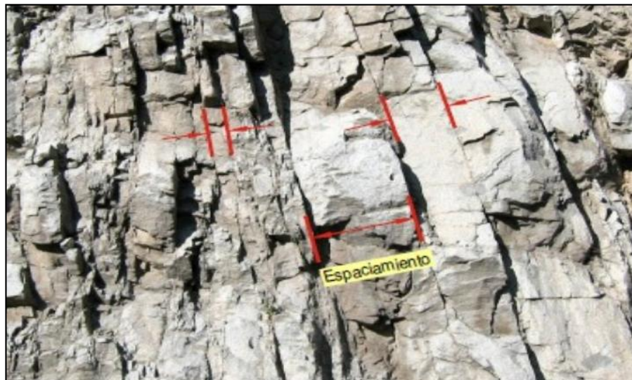
Figura N°6 Espaciamiento de discontinuidades sobre el macizo rocoso. Fuente diapositiva CGI.
