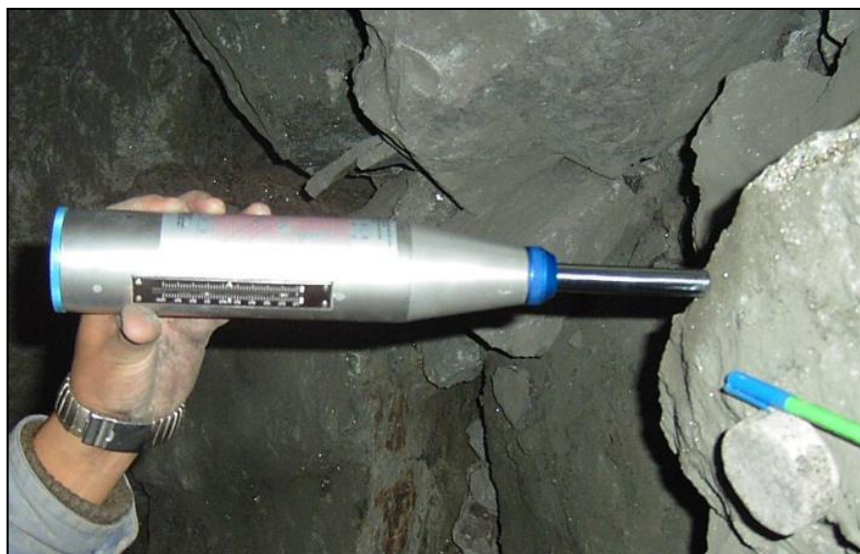
Figura N°2 Martillo de Schmidt en terreno. Fuente www.minexproduct.com
