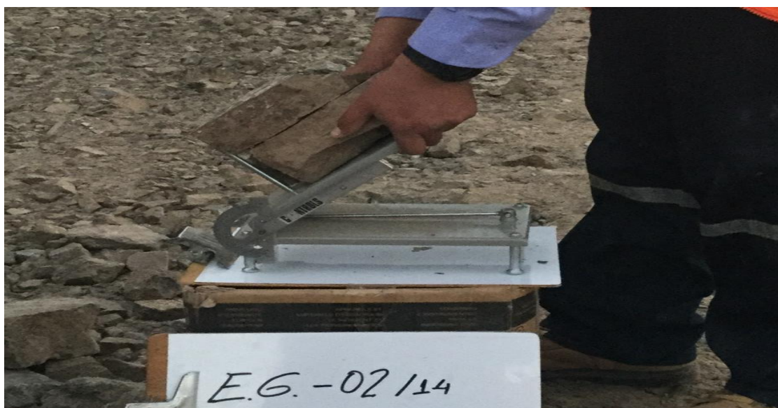
Figura N° 6-12 Ejecución del Ensayo Tilt Test (EG-02)
