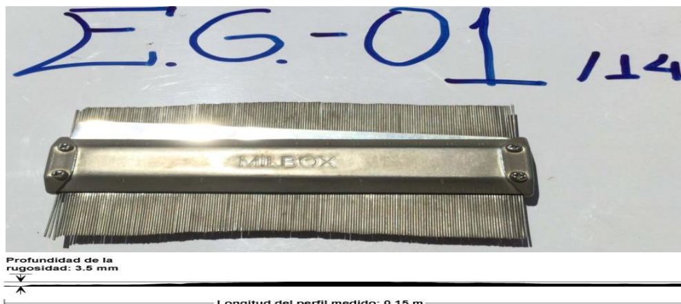
Figura N° 6-10 Vista del Perfil de Rugosidad de las Discontinuidades (EG-01)
