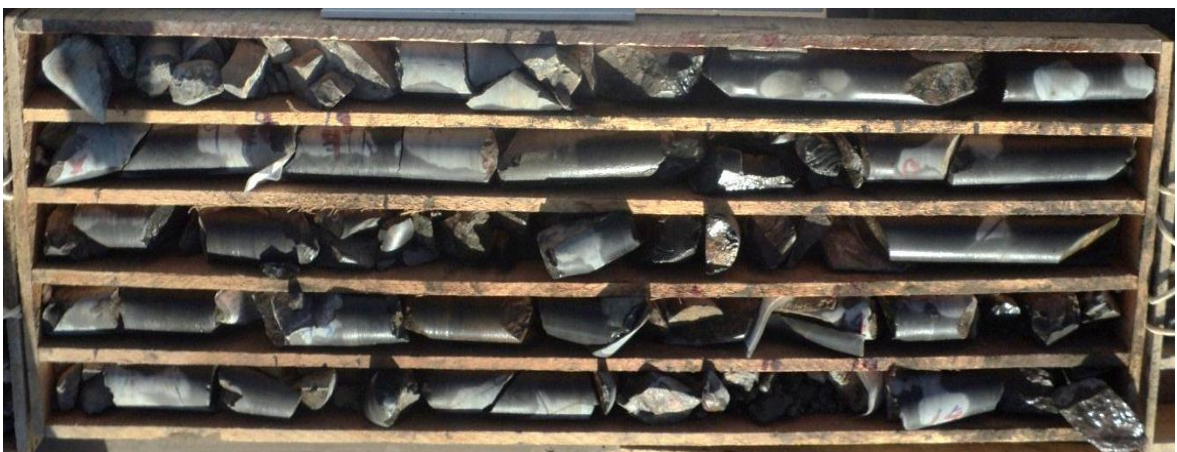
Figura N° 6-2 Vista de Caja de la Perforación Diamantina
