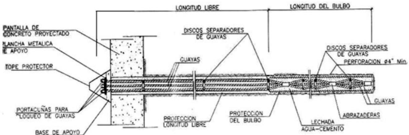
En el caso de anclajes definitivos, el diseño incorpora elementos complementarios requeridos para una adecuada protección contra la corrosión del tensor dentro del bulbo, como es el uso de un tubo plástico corrugado ranurado, suficientemente dúctil para no romperse al agrietarse la lechada, y lo suficientemente resistente, como para transmitir las fuerzas de corte de la lechada en contacto con el tensor.
